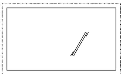
Fenêtre de sécurité composée de deux feuilles de verre de 3mm prenant en sandwich une feuille de mylar haute résistance
