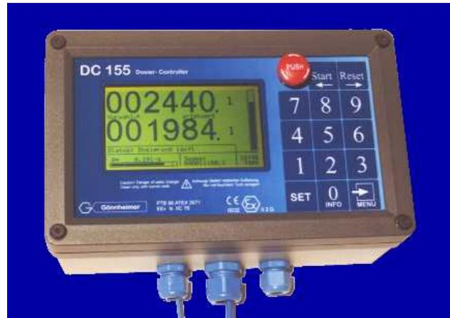
Le DC155 est un régulateur de dosage d'usage général pour piloter des processus de n'importe quel produit liquide ou solide dans une zone ATEX. Avec son clavier confortable, de larges touches (22x22mm), un afficheur clair et des fonctionnalités flexibles, il est possible de réaliser des processus simples ou compliqués directement dans la zone sans devoir recourir à de la filerie coûteuse ou des panneaux de contrôle hors zone.
