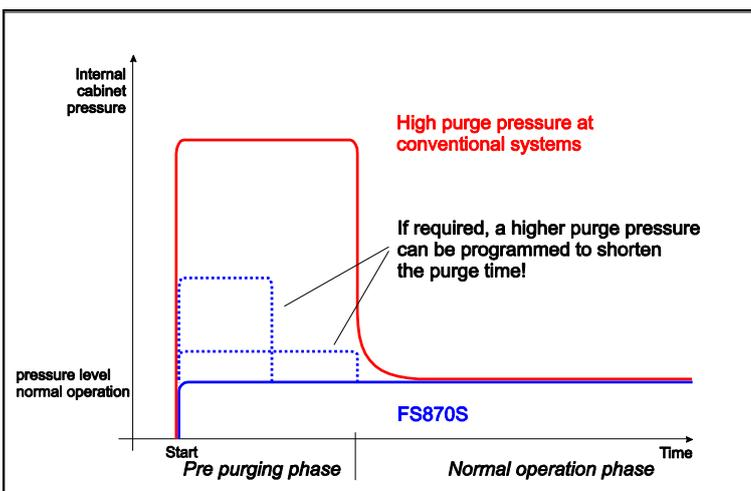
Sur les systèmes classiques de contrôle Ex-p, la pression de purge doit être réglée à des valeurs plusieurs fois supérieures à la pression pendant le fonctionnement normal, pour réaliser un système adéquat et une rapide phase de purge.
