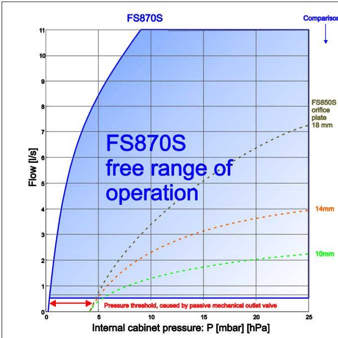
Au cours de la phase de purge, un débit élevé devrait être réalisé pour réduire le temps de purge. Sur la base de leur construction, les systèmes Ex-p classiques ne représentent qu'une faible augmentation du débit lorsque l'on augmente la pression dans l'enceinte.
